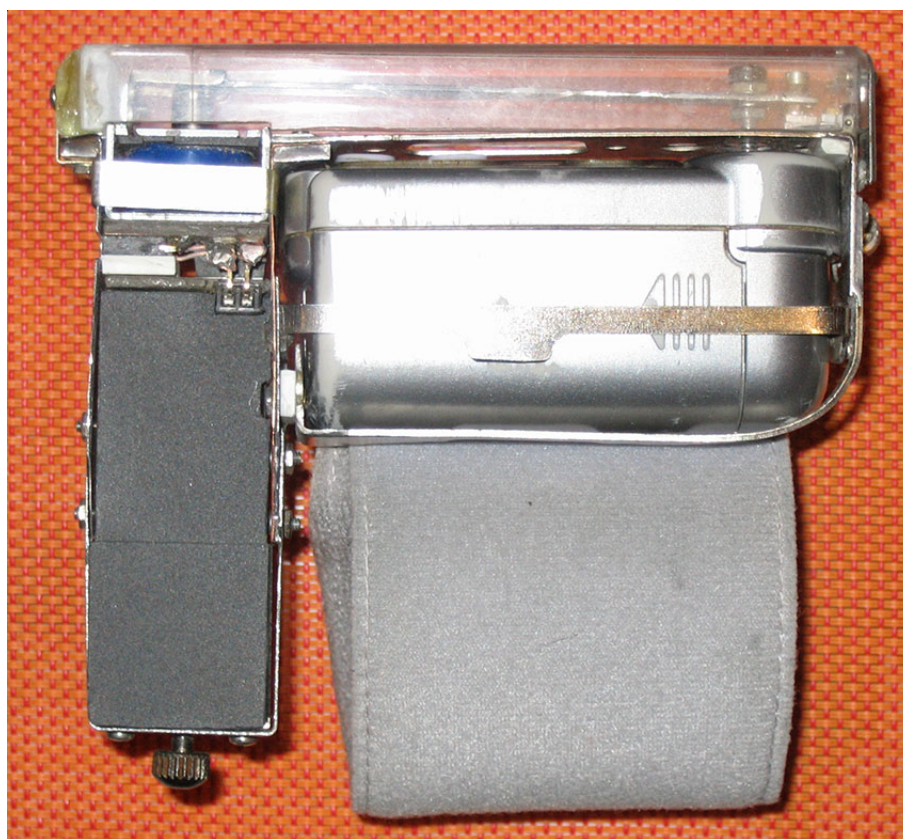
Рис. 11. Внешний вид устройства управления кнопкой On/Off , установленный на тонометре R7 фирмы Omron. (вид сзади).
