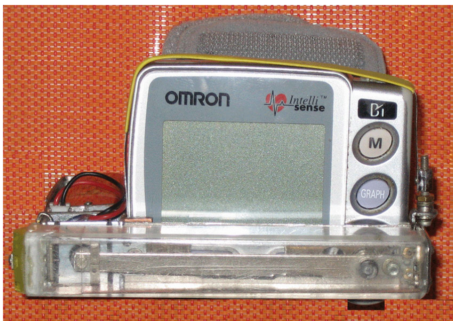
Рис. 10. Внешний вид устройства управления кнопкой On/Off , установленный на тонометре R7 фирмы Omron. (вид спереди).
